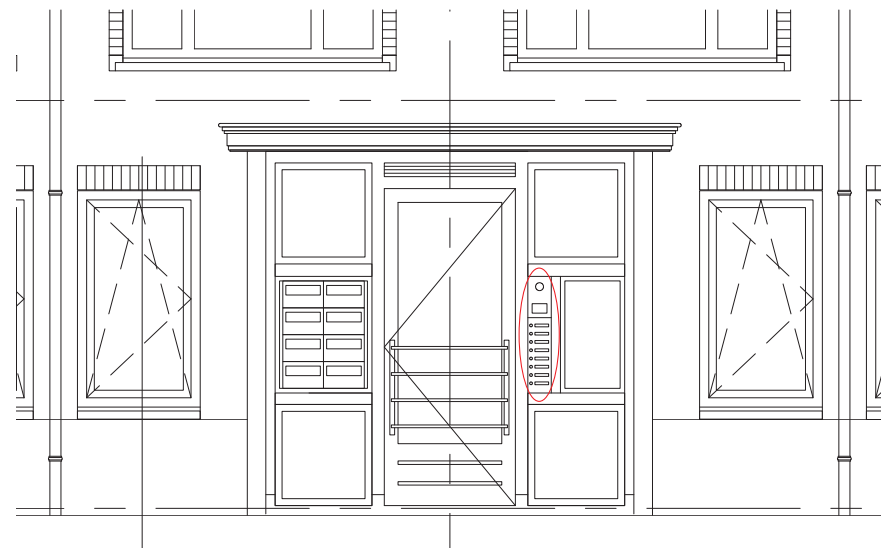
Figuur 3.1 Toegang woongebouw: geveltekening waarop een bellentableau is aangegeven.
