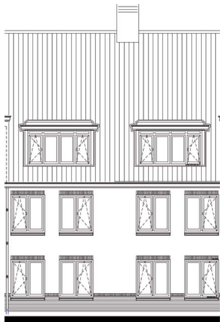
Figuur 3.37 Voorbeeld van een geveltekening waarop de draairichting van de beweegbare delen is aangegeven. De gestippelde lijnen geven aan dat de beweegbare delen naar binnen draaien.
